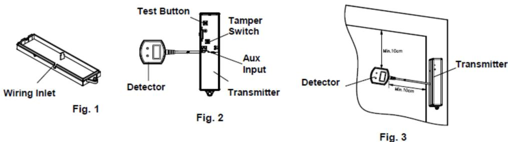
Lösen Sie die Schraube des Funksenders TX-3GS und öffnen Sie die Abdeckung. Verwenden Sie eine Zange oder einen Fräser, um den Kunststoff des Verdrahtungseinlasses zu brechen (Abb. 1). Verbinden Sie dann den Melder mit den AUX-Eingangsklemmen der Sender-Platine und legen Sie zwei AAA-Alkalibatterien ein. Siehe Fig. 2.
