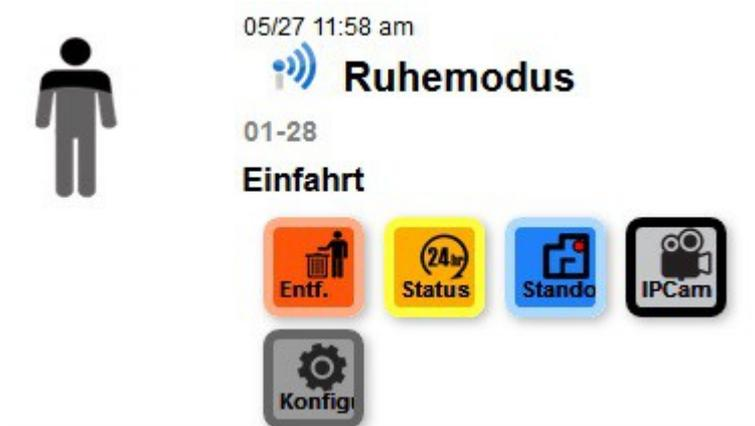
Der aktuelle Status des Sensors wird Ihnen durch entsprechende Symbole angezeigt, ebenfalls werden ggf. Meldungen über niedrigen Batteriestand, Melderverlust ausgegeben.
