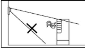
Vermeiden Sie es, den Sensor in Bereiche zu bringen, die Gegenstände enthalten, die eine schnelle Temperaturänderung bewirken können, wie z. B. Zentralheizungsstrahler oder Kanäle (oder Heizungen jeglicher Art), Klimaanlage, offene Flammen usw.
